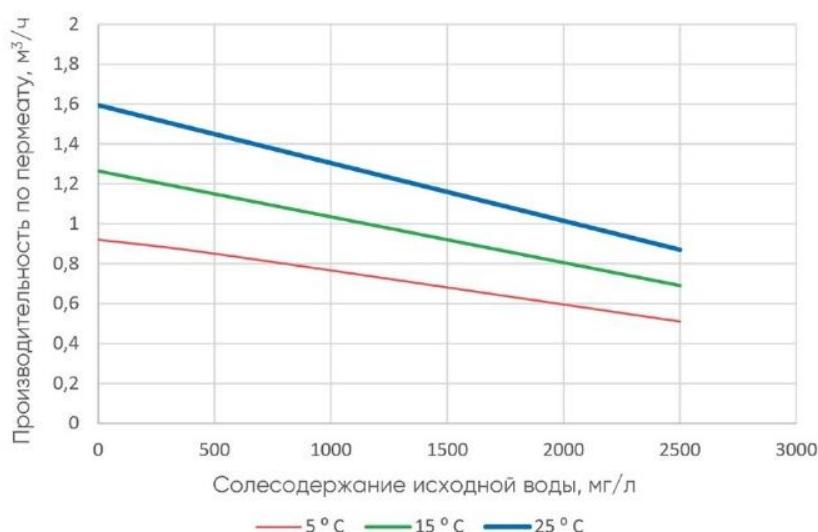
Расчетный график зависимости производительности обратного осмоса от общего солесодержания исходной воды при заданных температурах
