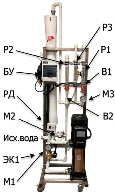
2.1.2 Мембранный блок предназначен для обессоливания воды на основе явления обратного осмоса и состоит из рулонного обратноосмотического элемента МЭ1, размещенного в нержавеющем корпусе.
